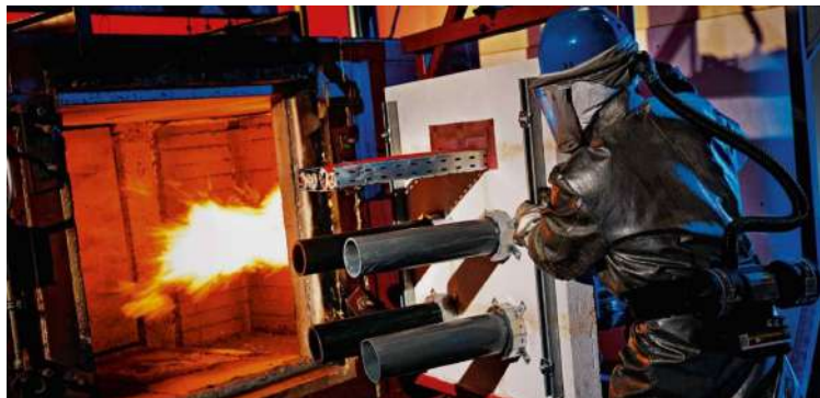
Figura 1: Prueba a sistemas de sello de penetraciones, Cortesía Hilti Chile
