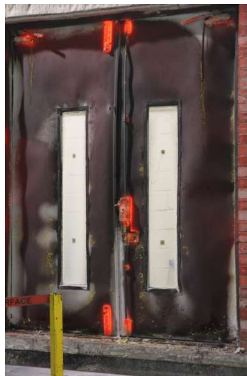
Ensayo de Puertas Resistentes al Fuego.
