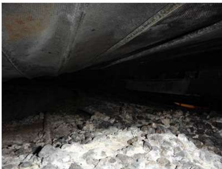
Figura 21 – Bandeja inferior de transporte de pellet. Se observa con material acumulado.
