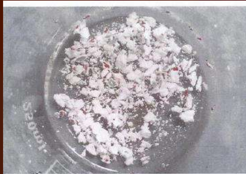
Figura 4-3 Prueba del ácido clorhídrico en labo
