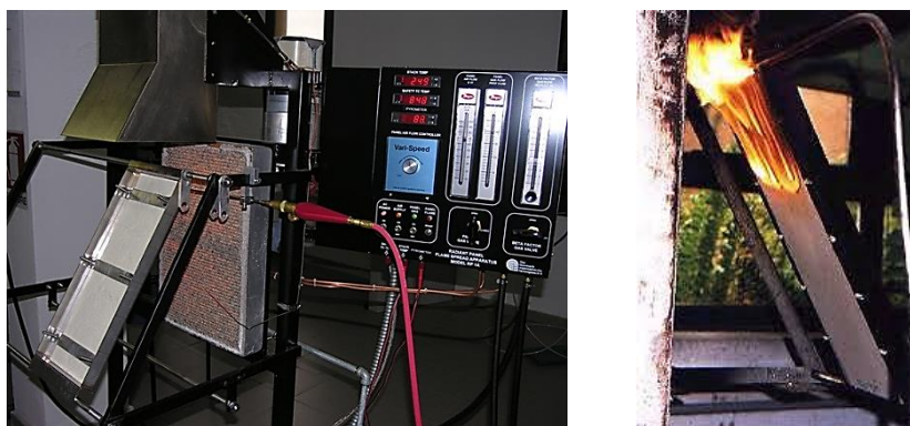
Figura 3 – Equipamento para ensaio de verificação da propagação superficial de chama
