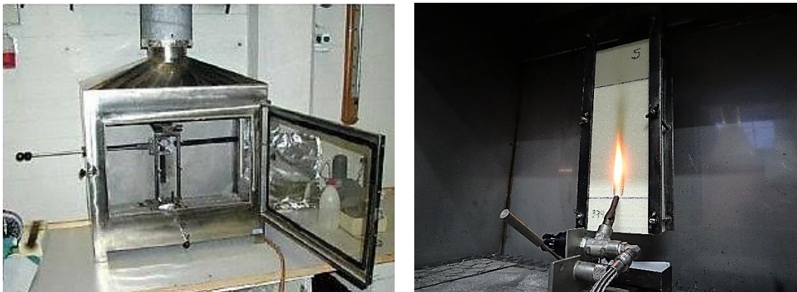
Figura 6 A – Equipamento para ensaio para verificação da ignitabilidade
