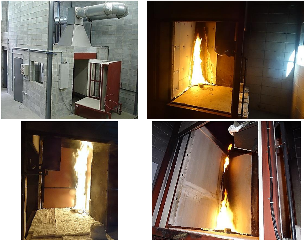
Figura 5 – Equipamento para ensaio Single Burning Item - SBI (EN 13823)
