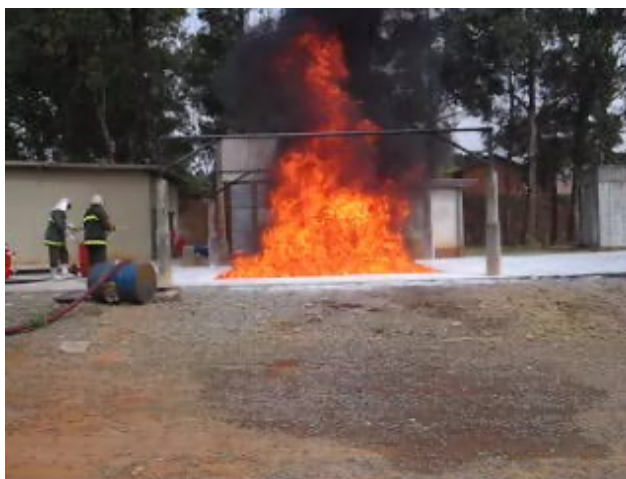
Figura 14 – Capacidade Extintora Classe B - 80 - B – Extintor sobre rodas de pó BC
