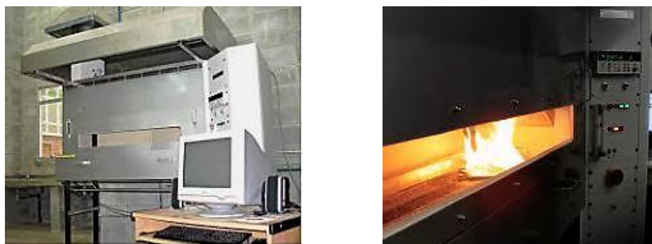
Figura 7 – Equipamento para ensaio para determinação da densidade crítica de fluxo de energia térmica (ABNT NBR 8660)
