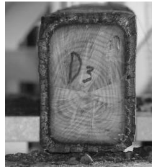
Figura 8 – Carbonização da madeira
