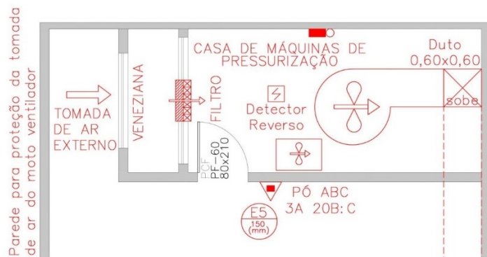
Figura 5 – Casa do motoventilador em pavimento cobertura
