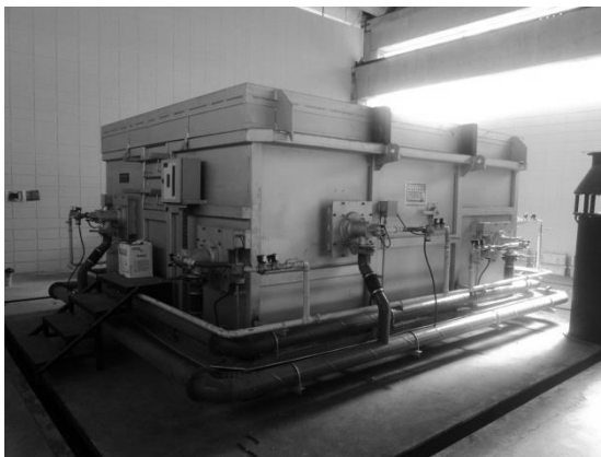
Figura 4 – Forno horizontal para ensaios de estruturas a altas temperaturas – USP/São Carlos
