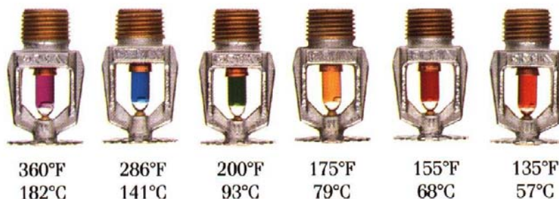
Figura 5 – Classificação dos bicos tipo ampola por temperatura
