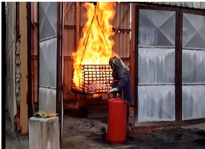
Figura 9 – Ensaio de fogo em Engradado de Madeira - Extintor sobre rodas de Espuma Mecânica Classe 10-A
