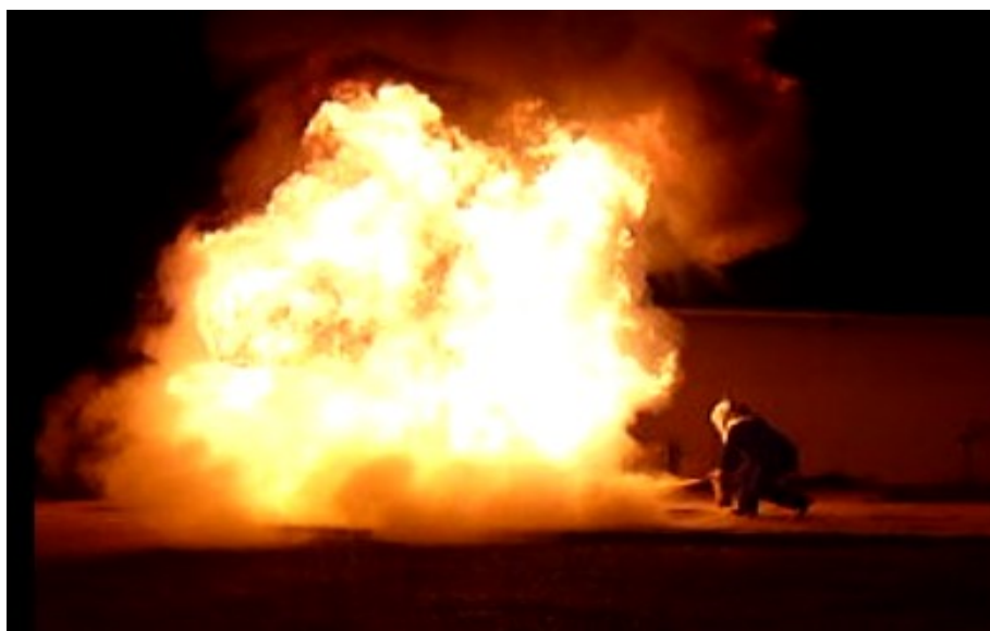
Figura 12 – Capacidade Extintora Classe B - 20 - B em pó ABC
