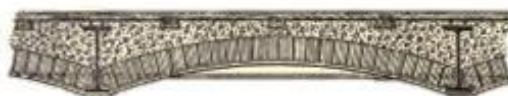
Figura 5 – O arco de tijolos como primeira forma de proteção de vigas metálicas
