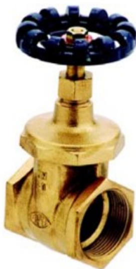
Figura 17 – Válvula Gaveta, haste não ascendente, DN 50 a DN 300, PN 20
