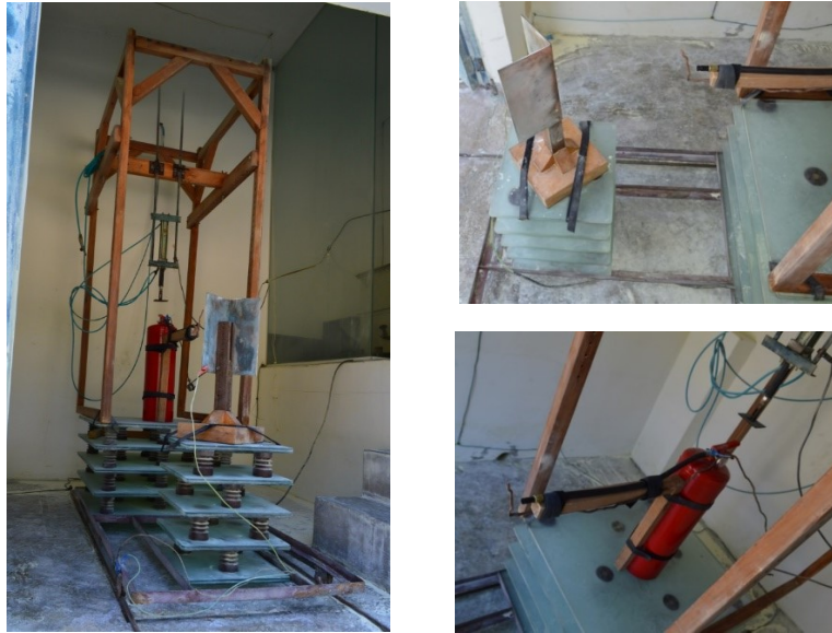
Figura 16 – Extintor portátil de pó no arranjo de ensaio e do aplicador de tensão
