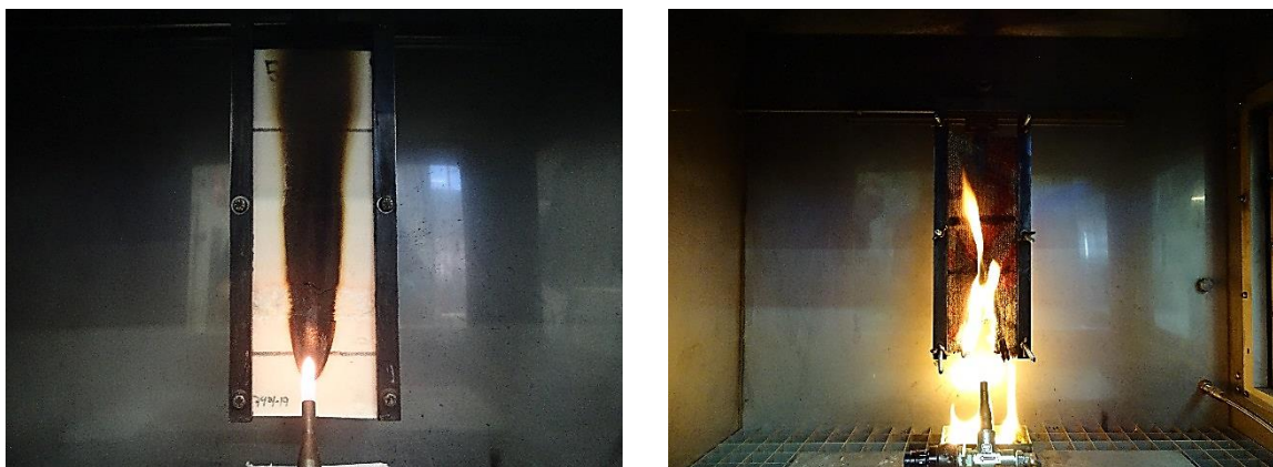
Figura 6 B – Equipamento para ensaio para verificação da ignitabilidade
