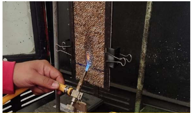
Figura 2: Ensayo de revestimientos textiles. Cortesía División Tecnología de la Construcción de IDIEM
