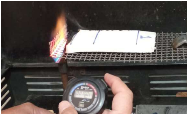
Figura 1: Ensayo de espumas plásticas. Cortesía División Tecnología de la Construcción de IDIEM
