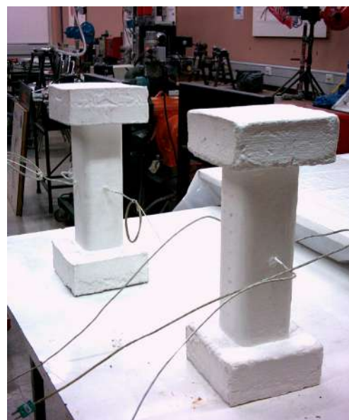
Perfiles de acero protegidos con intumescente. Probetas para ensayo
